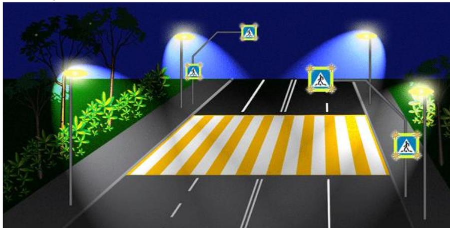
**Предлагаемый вариант улучшения распознаваемости места перехода: освещение всех пешеходных переходов, использование разноцветной разметки, использование знаков на световозвращающих щитах со световой индикацией, а также установка дублирующих дорожных знаков над проезжей частью**
